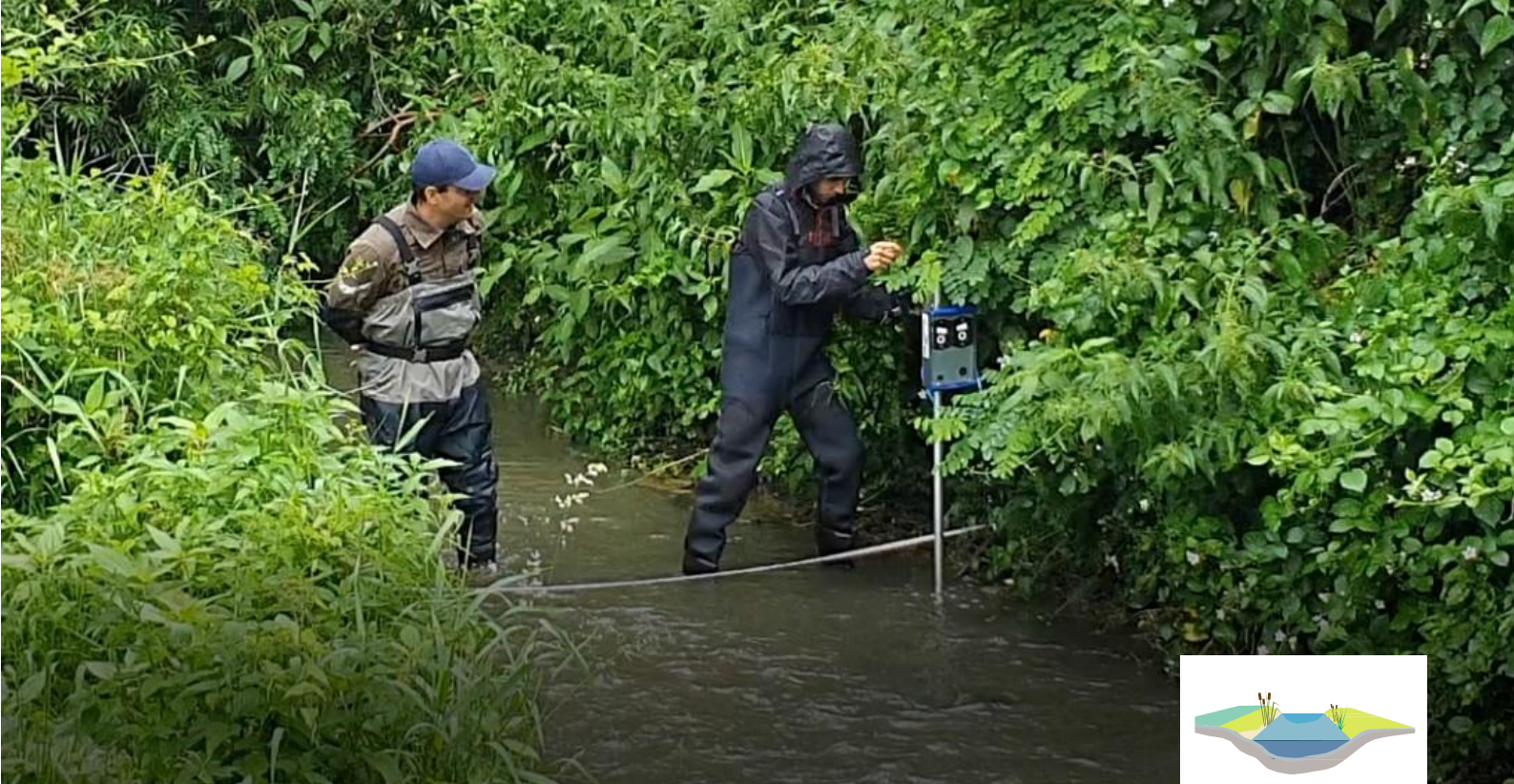
Medición del caudal con el NivuFlow Stick cerca de Hagenbach
