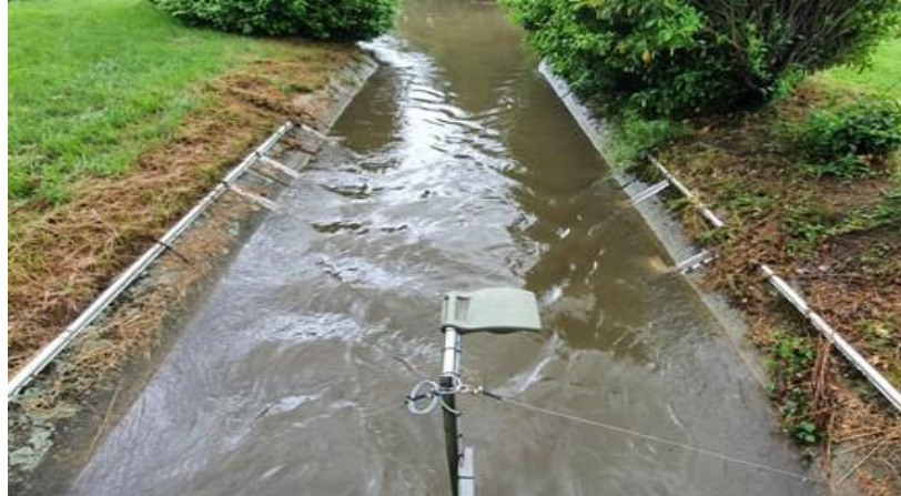
Medición de caudal con NivuFlow 650 en el antiguo molino de Friesen (canal trapezoidal)
