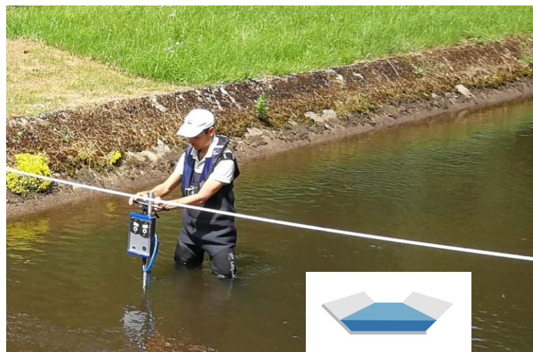
Medición del caudal con el NivuFlow Stick en un canal trapezoidal en Lorquin
