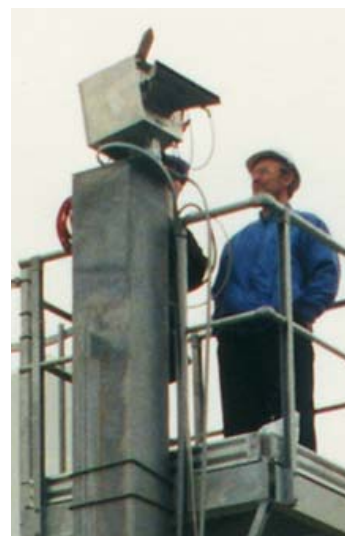
La caja protectora del explorador de líneas se monta en la parte superior de una torre
